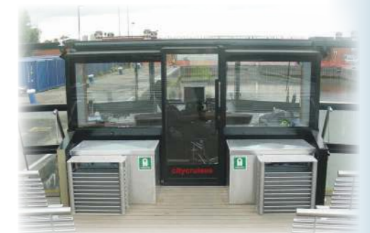
komplett verglastes Ruderhaus
